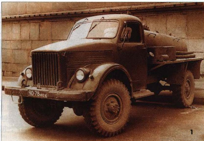
1. Это не асептическая машина, а автоцистерна АЦ-3 для транспортировки глинистого раствора, образующегося при бурении скважин. Такие цистерны на шасси ГАЗ-63 с 1955 по 1970 г. строил Шигровский механический завод. Фото автора
