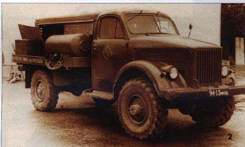
2. Передвижная компрессорная станция АПКС-30 на шасси ГАЗ-63. 1960 – 1970 гг. Фото автора
